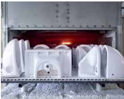
上釉毛坯置于熔炉中约16小时，加热到1200°C高温，制成成品。
